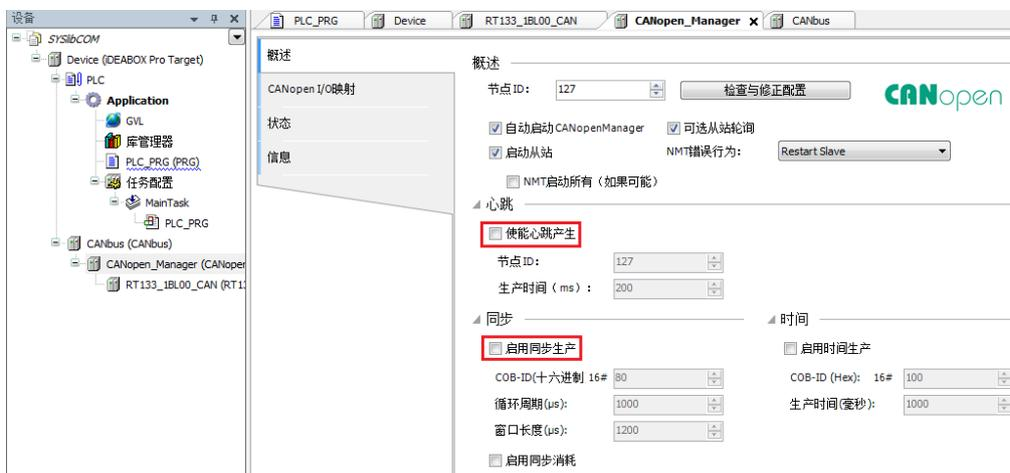
6. 双击新添加的“RT133\_1BL00\_CAN”设备,在新打开的概述选项中进行如下设置:配置节点 ID,使能专家设置,启动节点保护并设置保护时间和声明周期系数,取消启动心跳生产和检查供应商 ID 的设置。
